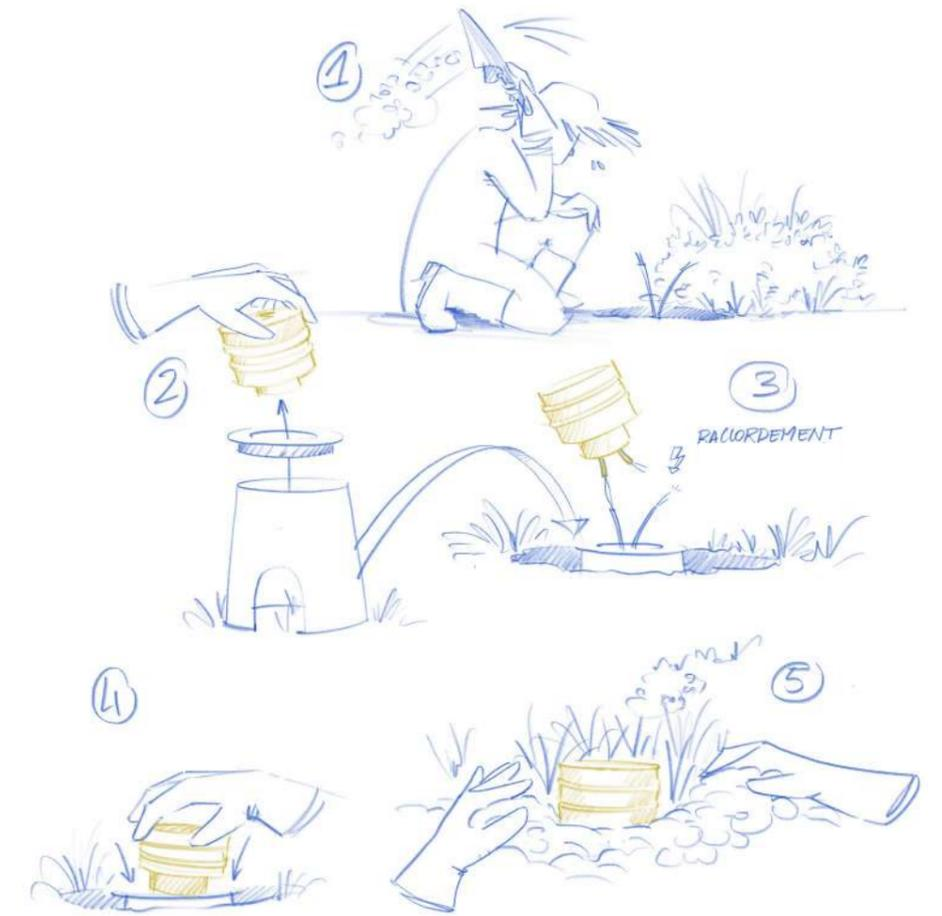
Le regard permet de ranger le surplus de câbles, en cas de déplacement du luminaire, et de protéger les câbles.
