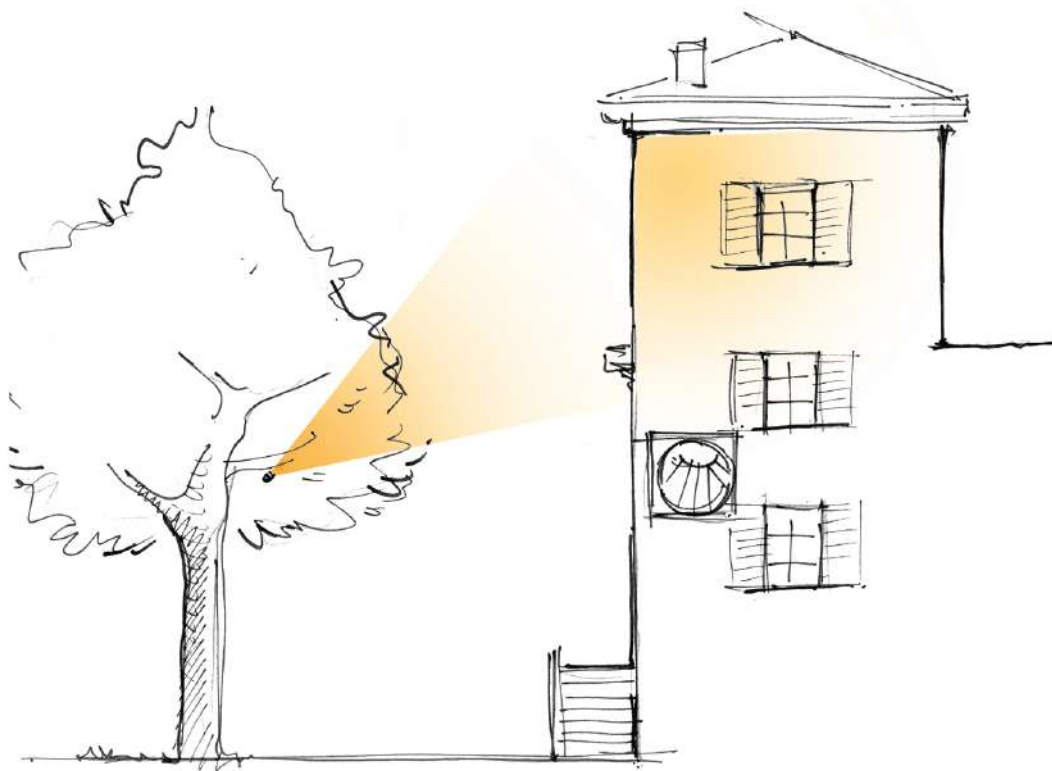
Sur les branches d'un arbre pour un éclairage de façade à distance...
